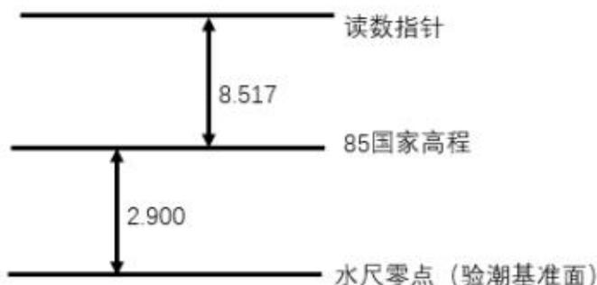
图 2.2.2-1 连云港验潮站高程关系图
